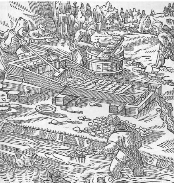
Abb. 849: Der mit Rasen belegte Herd. Das Haupt des Herdes A. Das kleine Gerinne, durch welches das Wasser auf das Haupt des Herdes fließt B. Die Rasen C. Der Trog unter dem Herde D. Das Faß, in dem die Rasen gewaschen werden E.
