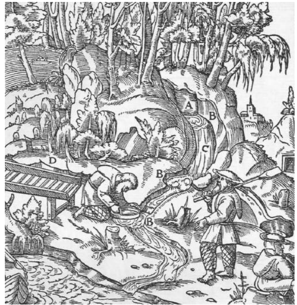
Abb. 861: Das Waschen der Zinnerze auf dem lusitanischen Herde. Die Schlucht A. Die Gräben B. Das strömende Wasser C. Der Herd der Lusitanier D.
