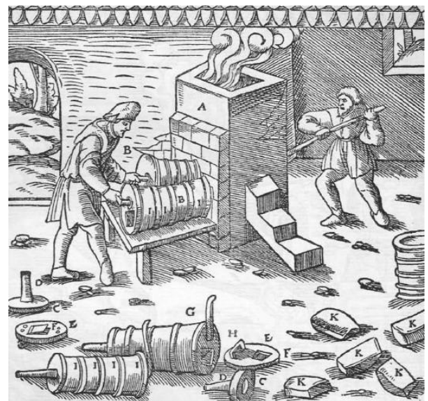
Abb. 922: Kleiner spanischer Zinnschachtlofen. Der Ofen A. Die Blasebälge B. Die eiserne Scheibe C. Die Düse D. Die hölzerne Scheibe E. Das Windventil F. Die Handhabe G. Der Henkel H. Die eisernen Ringe I. Zinnbarren K.
