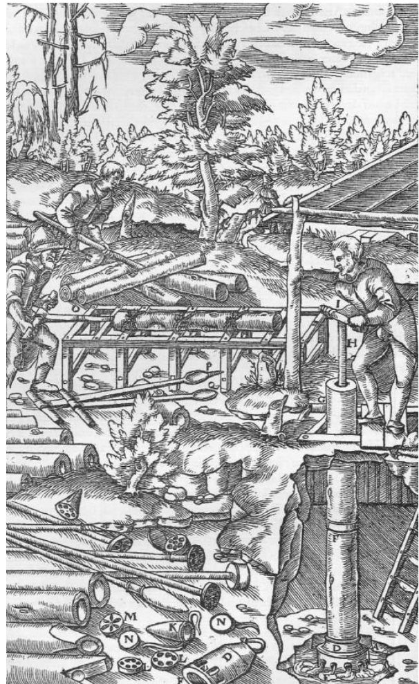
Abb. 624: Krückelpumpe, Pumpenrohre, Kolben, Ventile usw. Der Sumpf A. Die Rohre B. Das Schachtjoch C. Der Holzstock oder Saugkorb D. Die Löcher des Stockes E. Das Saugventil im Ring F [30]. Das Ausgußrohr G. Die Kolbenstange H. Der Griff I. Der Trichterkolben K. Der Kolben mit runden Löchern L. Der Kolben mit länglichen Löchern M. Das lederne Ventil N. Ein Schraubenbohrer P. Ein Löffelbohrer Q.
