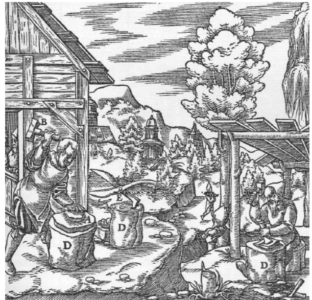
Abb. 802: Das Scheiden geschmeidiger Erze. Eine Stufe Erz A. Der Quetscher B. Der eiserne Meißel C. Der Stock D. Die Schere E.
