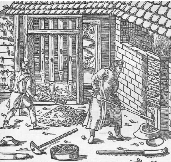
Abb. 909: Pochwerk zum Zerkleinern von Kohlen. Die Kohlen A. Der Pochtrog B. Die Pochstempel C.
