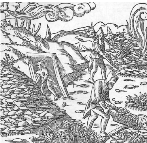
Abb. 810: Das Brennen der Mansfelder Kupferschiefer. Der Erzhaufen A. Der entzündete Erzhaufen B. Ein Arbeiter, der Schiefer auf das Strauchwerk schafft C.
