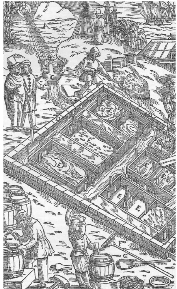
Abb. 1201: Salzgarten am Meer. Das Meer A. Die Lagune B. Schleuse C. Gräben D. Salzkrusten E. Rechen F. Schaufel G.
