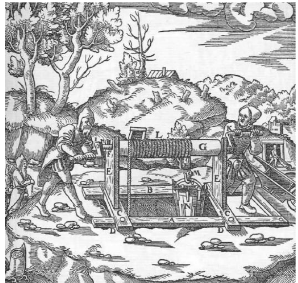
Abb. 613: Der Hornhaspel. Der vorn am Schacht verlegte Pfühlbaum A. Der hinten am Schacht verlegte Pfühlbaum B. Die zugespitzten Pfähle C. Die Querhölzer D. Die Haspelstützen E. Die Pfadeisen F. Der Rundbaum G. Sein Zapfen H. Das Holz L. Die Kurbel K. Das Förderseil L. Der Seilhaken M. Das Fördergefäß N. Sein Bügel O.
