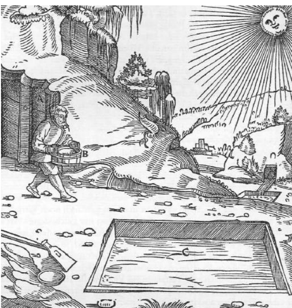
Abb. 1214: Die Verarbeitung vitriolhaltiger Stollenwässer. Der Stollen A. Der Bottich B. Der Sammelbehälter C.
