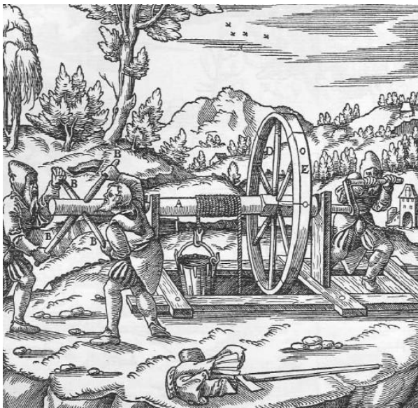
Abb. 614: Der Rad- oder Kreuzhaspel. Der Rundbaum A. Die geraden Stäbe, auch Haspelwinden genannt B. Das Haspelhorn C. Die Speichen des Rades D. Die Felgen E.
