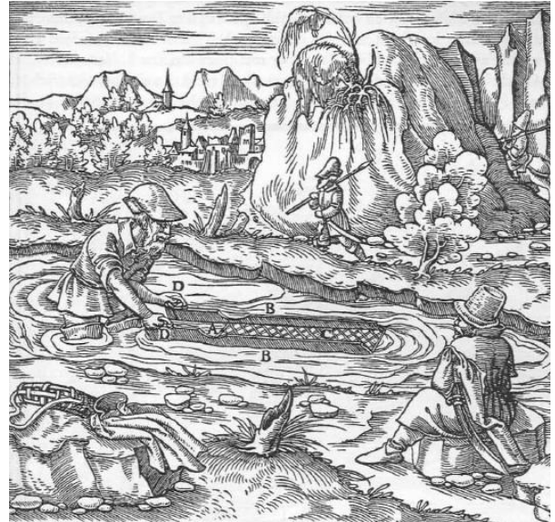
Abb. 841: Das Verwaschen der Golderze auf dem Herd mit gekreuzten Drähten. Das Bodenbrett A. Die Seitenbretter B. Die eisernen Drähte C. Die Handhaben D.
