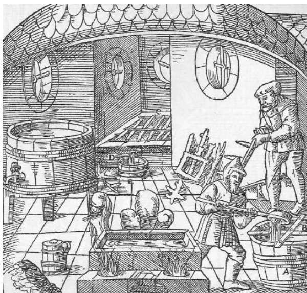
Abb. 1216: Das Laugen vitriolhaltiger Erden. Der Holzbottich A. Die Querstäbe B. Die Ruten C. Der Behälter mit geneigtem Boden D. Das darunter gestellte Gefäß E.
