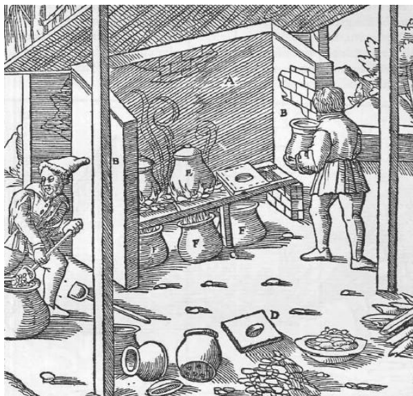
Abb. 1219: Die Gewinnung von Schwefel durch Ausschmelzen in Töpfen, die auf einem Herd stehen. Die lange Mauer A. Die hohen Mauern B. Die niedrigen Mauern C. Eisenplatten D. Die oberen Töpfe E. Die unteren Töpfe F.
