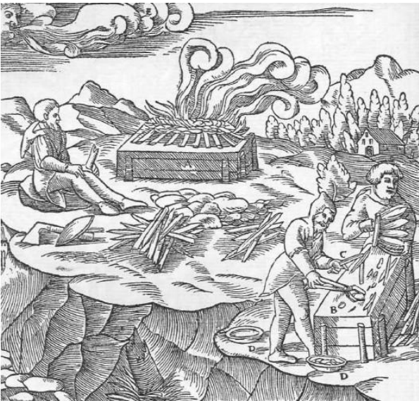
Abb. 933: Aussaigern von Wismut auf einer festen Feuerstätte. Die Feuerstätte, auf der das Erz erhitzt wird A. Die Feuerstätte, auf der ausgesaigerte Wismutkügelchen liegen B. Die Zange C. Die Mulde D. Der Wind E.
