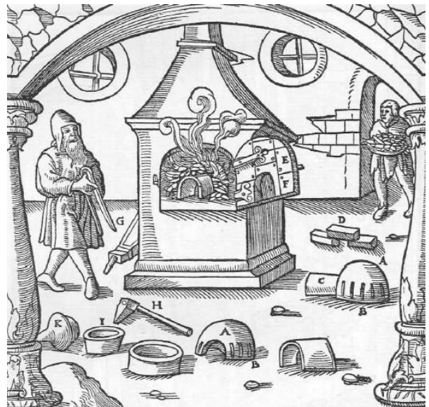
Abb. 1017: Das Feinbrennen des Silbers unter der Muffel. Die Muffel A. Ihre Fensterchen B. Ihr Steglein C. Backsteine D. Die Eisentür E. Ihr Fensterchen F. Der Blasebalg G. Das meißelförmige Gerät H. Der Eisenring, den manche an Stelle eines Testscherbens verwenden I. Das Pistill zum Stampfen der Asche im Ring K.
