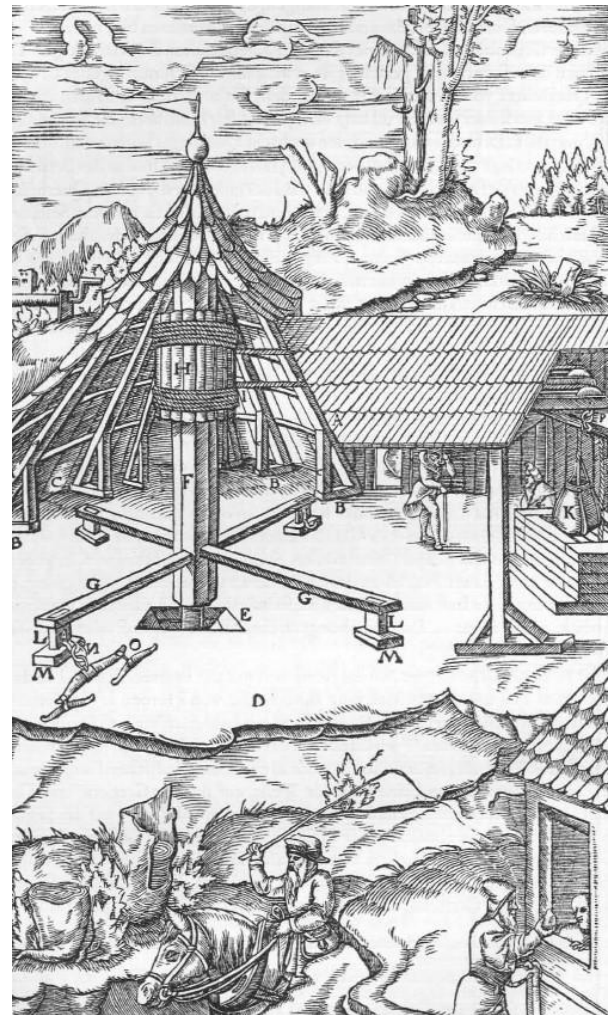
Abb. 616: Der Pferdegöpel. Die Sparren A. Die Schuhe B. Die Steifen C. Der Umlauf im Göpel D. Der Holzklotz für das Fußlager E. Die Welle F. Die Schwengel G. Der Seilkorb H. Die Seile I. Das Fördergefäß K. Die in die Schwengel eingesetzten Hölzer L. Der Schemel für den Treiber, an den auch die Pferde gespannt werden M. Die Kette N. Die Wage O. Der Sturzhaken P.
