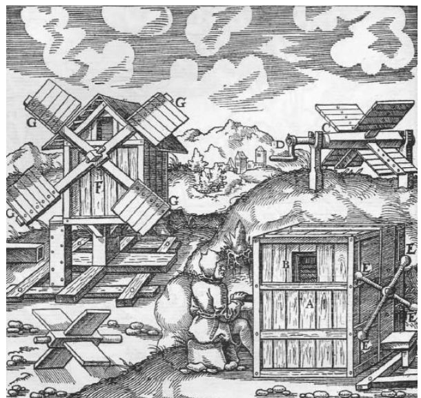
Abb. 643: Wetterrad mit Windantrieb und mit Handantrieb. Das auf den Boden gesetzte Gehäuse A. Sein Windloch B. Der Rundbaum mit Flügeln C. Die Kurbel D. Die am Rundbaum befindlichen Stangen E. Das auf hölzerne Böcke gestellte Gehäuse F. Die Flügel der Welle, außerhalb des Gehäuses G.
