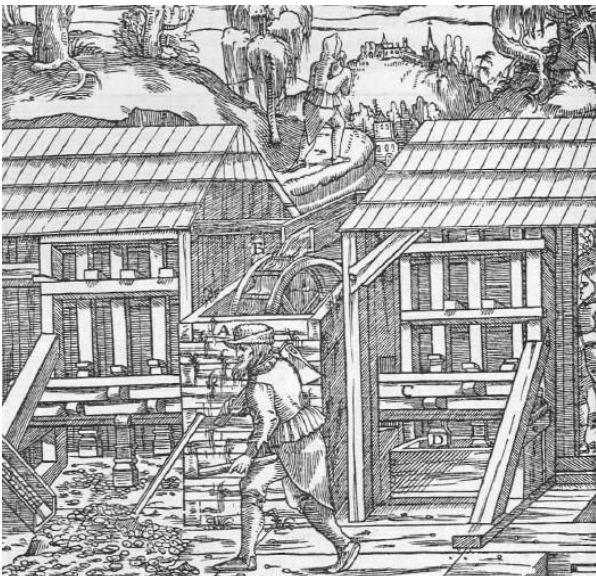
Abb. 813: Die Radstube für das Pochwerk. Der Schrot A. Dieser ist am oberen Teil geschlossen, hier ist er offen dargestellt, damit man das Rad sehen kann. Das Rad B. Die Welle C. Die Stempel D.
