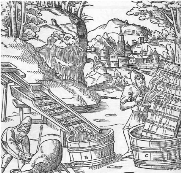
Abb. 844: Das Verwaschen der Golderze auf dem Herd mit Querrillen. Die Querrinnen A. Das Unterfaß B. Das andere Faß C.
