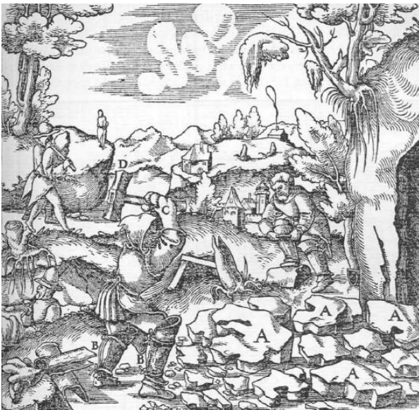
Abb. 804: Das Vorschlagen der kiesigen Erze am Rammelsberg. Kiese A. Rinden B. Die Handschuhe C. Das Fäustel D.
