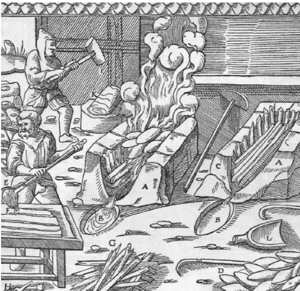
Abb. 921: Zinnsaigerherd. Der Saigerherd A. Der Vorherd B. Die Hölzer C. Zinnkuchen D. Die Kelle E. Die Kupferplatte F. Die Gitter G. Signiereisen H. Der hölzerne Hammer I. Das Ballenzinn K. Schippe L.
