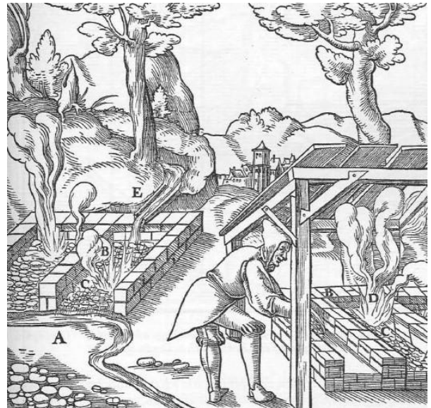
Abb. 806: Röststadel. Der Röststadel A. Die Hölzer B. Das Erz C. Die Gestalt des Kegels D. Das Wassergerinne E.
