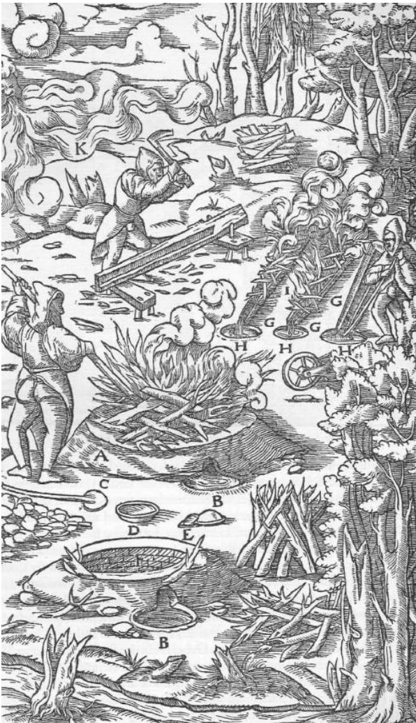
Abb. 931: Aussaigern von Wismut in Gruben oder Rinnen. Die Grube mit darübergerlegten Holzscheiten A. Der Vorherd B. Die Kelle C. Eiserne Gußformen D. Metallkuchen E. Leere, mit Steinen ausgekleidete Grube F. Holzrinne G. Die Sammelgruben der Rinnen H. Das über die Rinnen gelegte kleine Holz I. Der Wind K.
