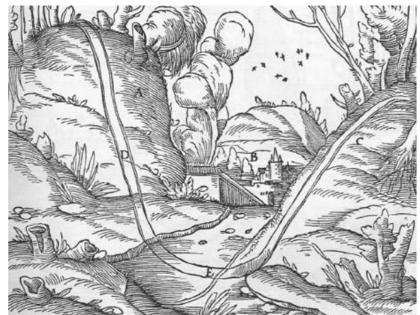
Abb. 319: Gang, der ein Tal durchsetzt. Das Berggehänge A, C. Ein Tal B. Der Gang D, E, F.
