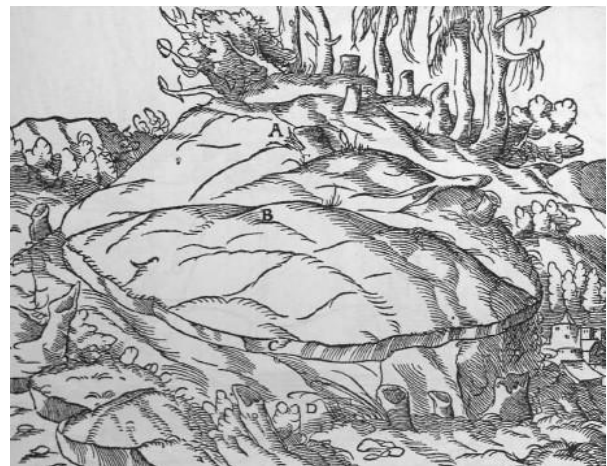
Abb. 302: Schwebender Gang oder Flöz. Das Gebirge A, D. Das Flöz oder der schwebende Gang B, C.
