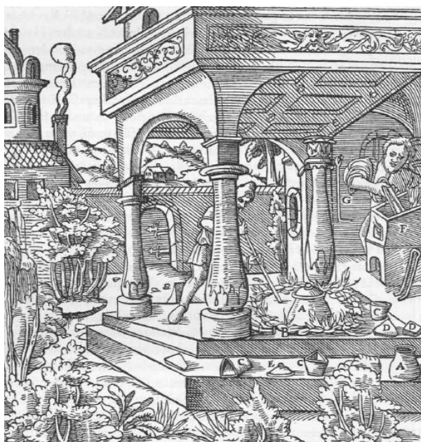
Abb. 1003: Die Scheidung des Goldes vom Silber im Guß mit Schwefel. Der Topf A, von glühenden Kohlen B umgeben. Der Tiegel C. Sein Deckel D. Der Deckel E des Topfes. Der Windofen F. Der Eisenstab G.
