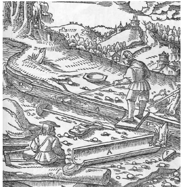
Abb. 851: Das Waschen des Goldsandtes im Waschtrog. Der Trog A. Sein offenes Ende B. Sein geschlossenes Ende C. Der Bach D. Die Kiste E. Das Bretttehen F. Die lederne Tasche G.
