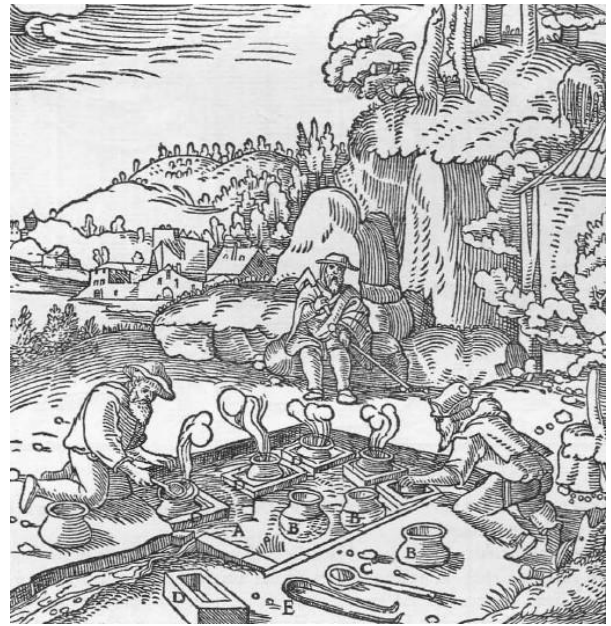
Abb. 1205: Das Eindampfen der Sole heißer Quellen in kleinen Töpfen. Die Sammelgrube A. Die Töpfe B. Schöpflöffel C. Die Pfanne D. Die Zange E.
