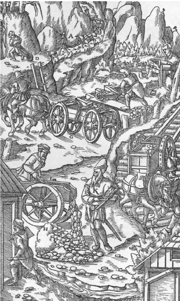
Abb. 619: Förderung auf Saumtieren, mittels Lutten, in Schubkarren, in zweirädrigen Karren und im Wagen. Pferde mit Saumsätteln A. Eine Sturzrolle, geneigt an den Felsen gestellt B. Die zugehörigen Bretter C. Der Karren mit einem Rade D. Der zweirädrige Karren E. Die Baumstämme F. Der Wagen G. Das Erz wird vom Wagen abgeladen H. Die Riegel I. Der Steiger, der die Anzahl Wagen am Kerbholz verzeichnet K. Die Behälter, in die die Erze zur Verteilung geworfen werden L.
