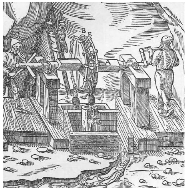
Abb. 635: Heizenkunst mit Antrieb durch Handhaspel. Der Rundbaum A. Der Kettenkorb B. Die Förderkette C. Die Taschen D. Die Klammern E.
