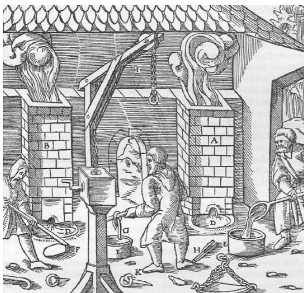
Abb. 1106: Öfen zum Verschmelzen von Schlacken und zur Herstellung der Frischstücke. Der Ofen zum Verschmelzen der Schlacken A. Der Ofen zum Legieren von Kupfer mit Blei B. Tür C. Der in die Erde eingelassene Spurtiegel D. Kupferne Form E. Das Streichholz F. Der Haken G. Das gespaltenes Holz H. Der Ausleger des Kranes I; sein Kettenhaken K.
