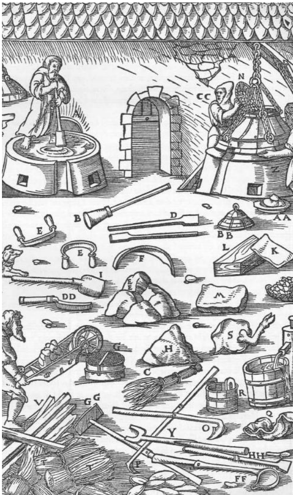
Abb. 1007: Das Schlagen des Herdes im Treibofen. Der Treiber A stampft den Herd mit dem Stößel. Der größere Stößel B. Der Besen C. Die zwei kleineren Stößel D. Das Schabeisen E. Der hölzerne Schaber F. Das Sieb G. Die Asche H. Die eiserne Schaufel I. Das Eisenblech K. Der Holzklotz L. Der Quaderstein M. Der Spankorb N. Der Glätthaken O. Die andere Ausführung
