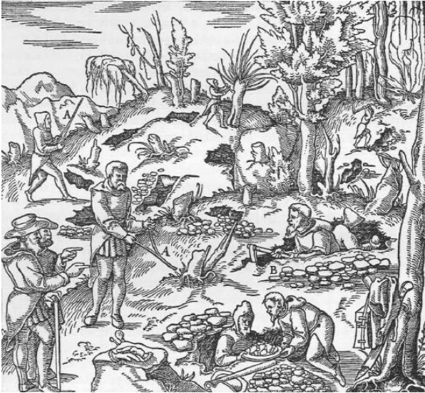
Abb. 201: Aufsuchen der Gänge mit der Wünschelrute und durch Schürfgräben. Die Wünschelrute A. Ein Schürfgraben B.
