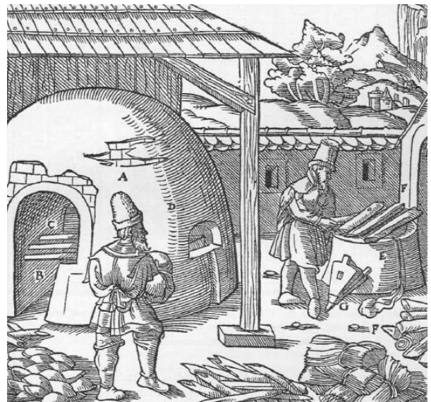
Abb. 1012: Der polnische und ungarische Treibofen. Ein backofenartiger Ofen A. Die Gasse B. Der Eisenrost C. Die Arbeitsöffnung, durch welche man die Glätte abzieht D. Ein Herd ohne Treibehut E. Die dicken Holzscheite F. Der Blasebalg G.
