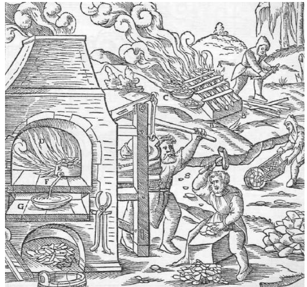
Abb. 932: Aussaigern von Wismut in eisernen Tiegeln mit und ohne Abfluß. Die Hölzer A. Die Ziegelsteine B. Die Gußform C [65]. Der Ofen D. Der Tiegel E. Das Abflußrohr F. Der untergestellte Tiegel G.
