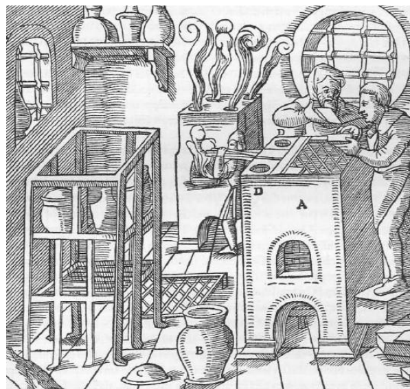
Abb. 1005: Die Scheidung des Goldes vom Silber durch Zementation. Der Ofen A. Der Topf B. Der Deckel C. Die Windlöcher D.
