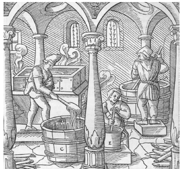
Abb. 1210: Die Bereitung der Soda. Kufe, in der Soda mit Harn vermischt wird A. Die Pfanne B. Kufe, in der sich die Chrysoykolla abscheidet C. Kupferstäbe D. Mörser E.
