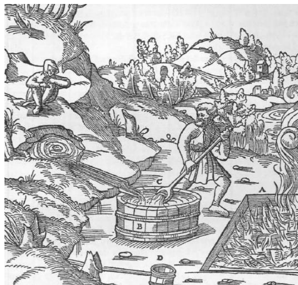
Abb. 1207: Das Eindampfen der Sole durch Gießen auf brennendes Holz. Die ausgehobene Grube A. Gefäß, in das die Sole geleitet wird B. Schöpflöffel C. Schöpfer mit eingelassenem Stiel D.
