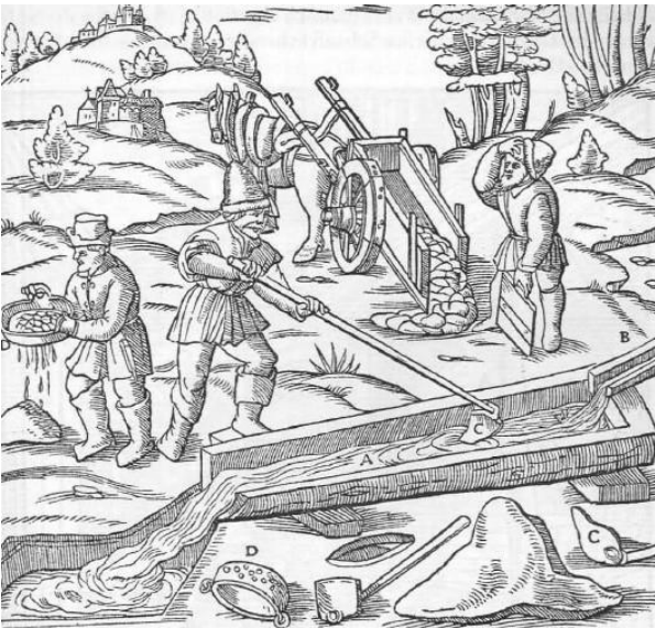
Abb. 862: Das Waschen der Bleierze in Polen. Der Graben A. Das kleine Gerinne B. Die Kratze C. Das Sieb D.
