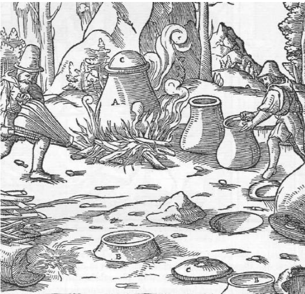
Abb. 1220: Die Gewinnung von Schwefel durch Ausschmelzen in einem Topf, der auf einem zweiten, in die Erde gegrabenen, steht. Das obere Gefäß A. Das untere Gefäß B. Der Deckel C.
