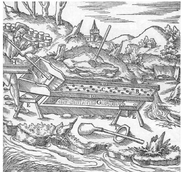
Abb. 839: Das Verwaschen der Golderze auf dem gelochten Herde. Das Haupt des Herdes A. Der Herd B. Die Löcher C. Die Seitenbretter D. Die Schemel E. Die Kiste F. Der Waschtrog G. Das Gerinne H. Der Sichertrög I.
