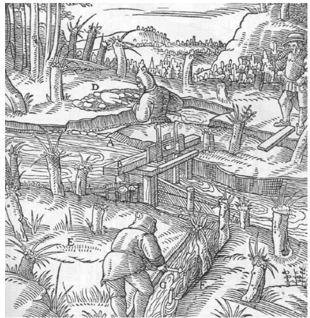
Abb. 836: Das Wehr und die Gräben am Flusse zum Auffangen der feinsten Zinnerzschliche. Der Fluß A. Das Wehr B. Der Schützen C. Der Graben D. Die Wiese E. Der Zaun F. Der Graben G.
