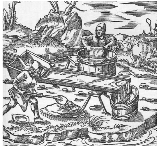
Abb. 847: Der Herd mit dem grünen Tuche. Das Haupt des Herdes A. Der Herd B. Das Tuch C. Das kleine Gerinne D. Das unter dem Herd aufgestellte Faß E. Das Faß, in dem das Tuch gewaschen wird F.
