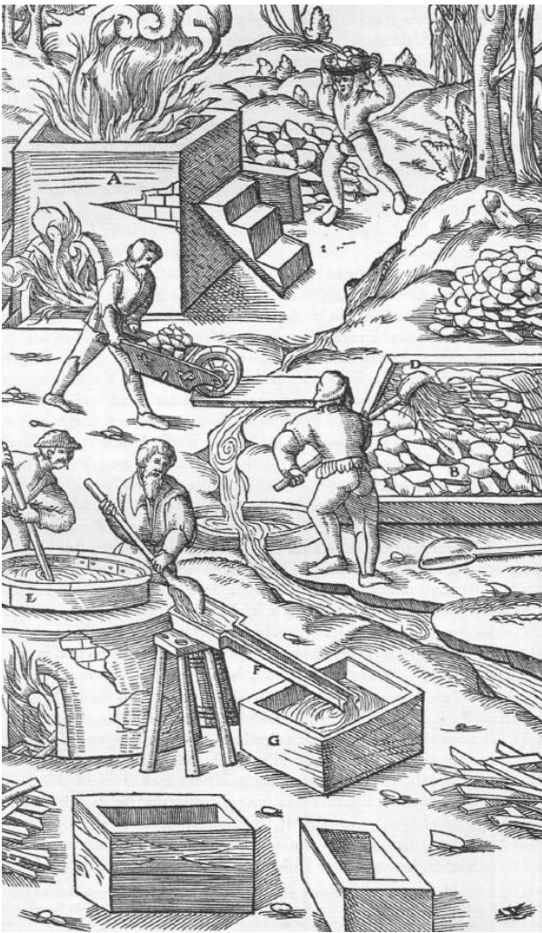
Abb. 1213: Die Auslaugung alauhaltiger Gesteine. Der Ofen A. Platz für die Lagerung des Gesteins B. Gestein C. Schöpflöffel D. Der Kessel E. Die Rinne F. Die Wanne G.
