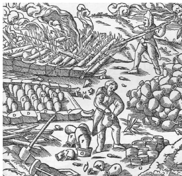
Abb. 926: Quecksilbergewinnung in aufeinandergestellten Töpfen. Die brennende Feuerstätte A. Die Hölzer B. Die nicht brennende Feuerstätte, in welche die Töpfe eingesetzt werden G. Die Steine D. Die Topfrehen E. Die oberen Töpfe F. Die unteren Töpfe G.
