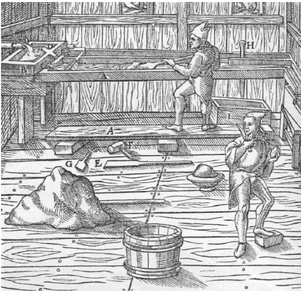
Abb. 856: Das Waschen der Zinnerze im Läutertrog und Gerinne. Die Gräben A. Der Trog B. Das kleine Gerinne C. Der runde Zapfen D. Die hölzerne Schaufel E. Der hölzerne Hammer F. Die hölzerne Schaufel mit kurzem Stiel G. Der im Gerinne angebrachte Zapfen H. Der darunter gestellte Trog I.
