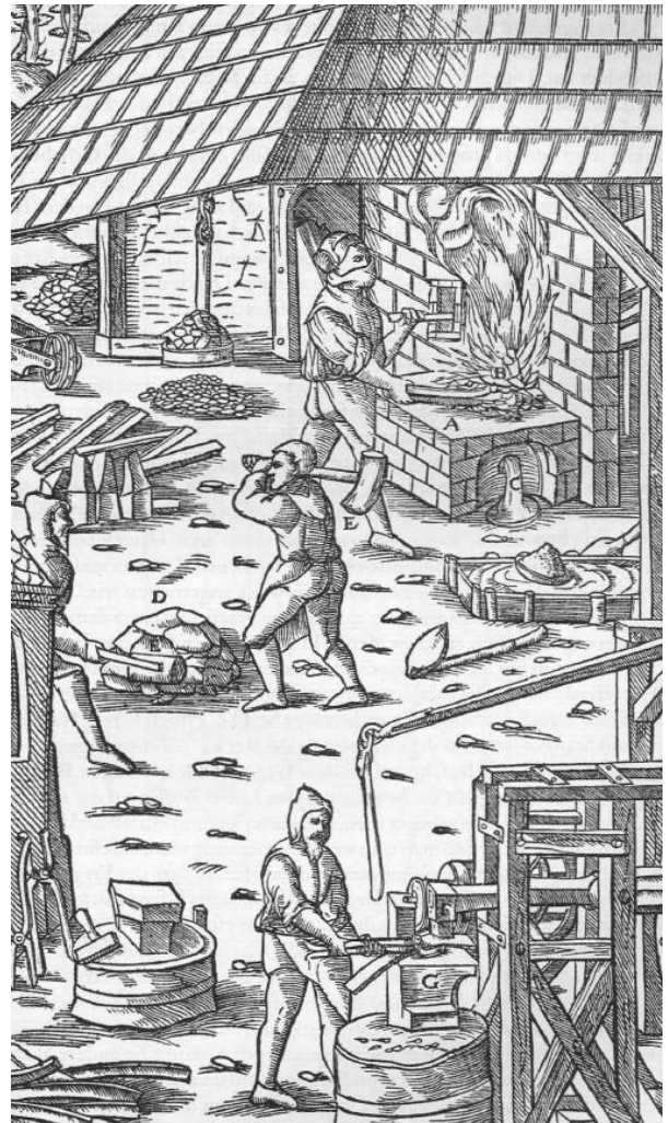
Abb. 923: Rennfeuer und Schwanzhammer. Der Herd A. Der Beschickungshaufen B. Der Schlackenabfluß C. Der Eisenklumpen (Massel) D. Die Holzhämmer E. Der große eiserne Hammer F. Der Amboß G.
