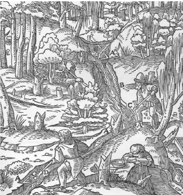
Abb. 860: Das Waschen der Zinnerze im Bach und in Waschtrögen. Die Tröge A. Der Gießbach B. Die Seifengabel C. Die Schaufel D.
