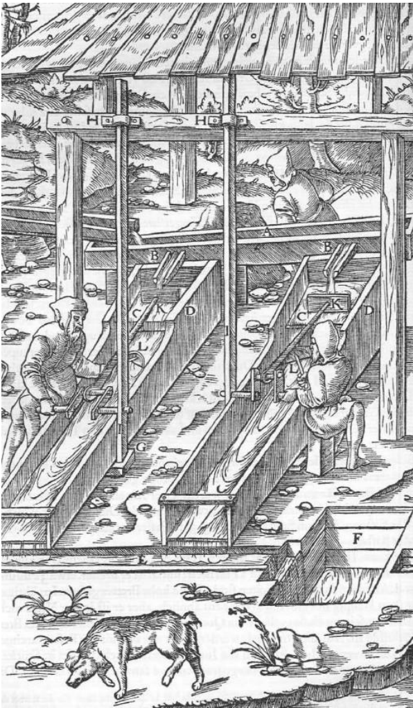
Abb. 826: Das Waschen der Erze im doppelten Schlämmgraben. Das oben Quergerinne A. Seine Auslässe B. Die Häupter der Schlämmgräben C. Die Schlämmgräben D. Der untere Quergraben E. Der Trog F. Das Lager in der Grundschwelle G. Die am Boden angeschlagenen Halbringlager H. Die Stange I. Ihre Kiste K. Die andere Kiste L.
