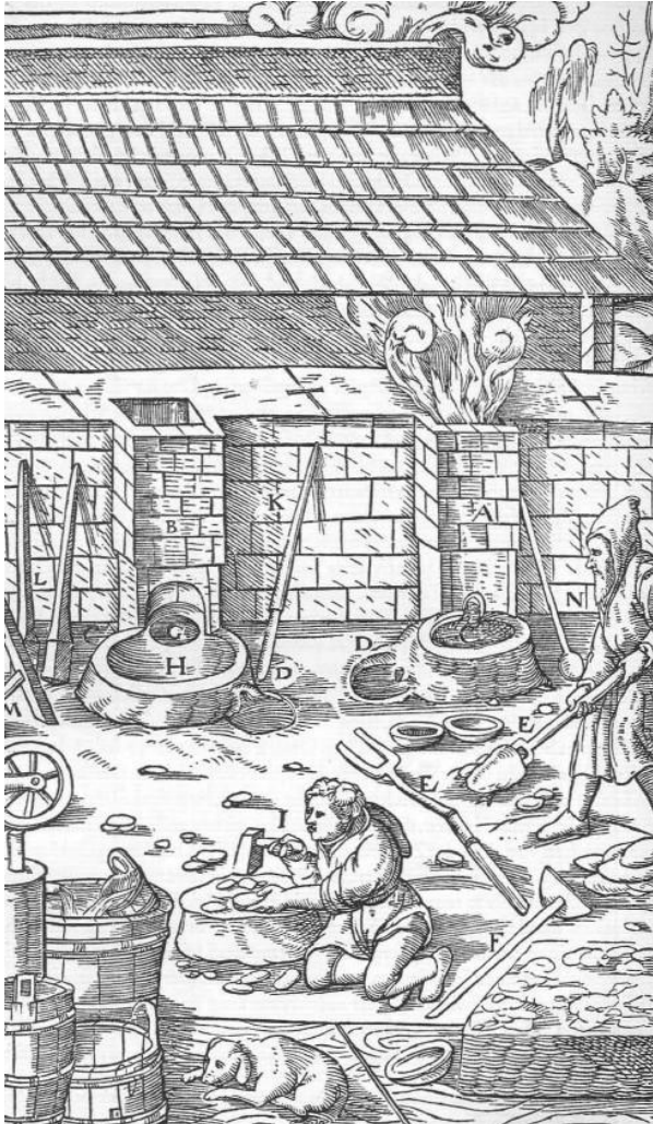
Abb. 915: Sumpfofen mit Sumpf und Vorherd. Zwei Öfen A und B. Der obere Vorherd C. Der untere Vorherd D. An dem einen Ofen steht der Arbeiter und entfernt mit einer eisernen Gabel die Schlacken. Die Gabel E. Die hölzerne Krücke, mit welcher der aus den Kiesen erschmolzene Stein abgezogen wird F. Beim zweiten Ofen der in das Ofeninnere hineinragende Teil des oberen Vorherdes G. Der außerhalb befindliche Teil H. Der Vorarbeiter, der den Vorherd vorrichtet, aber abseits vom Ofen I. Die Stange K. Der hölzerne Stampfer L. Die Treppe M. Die Kelle N.
