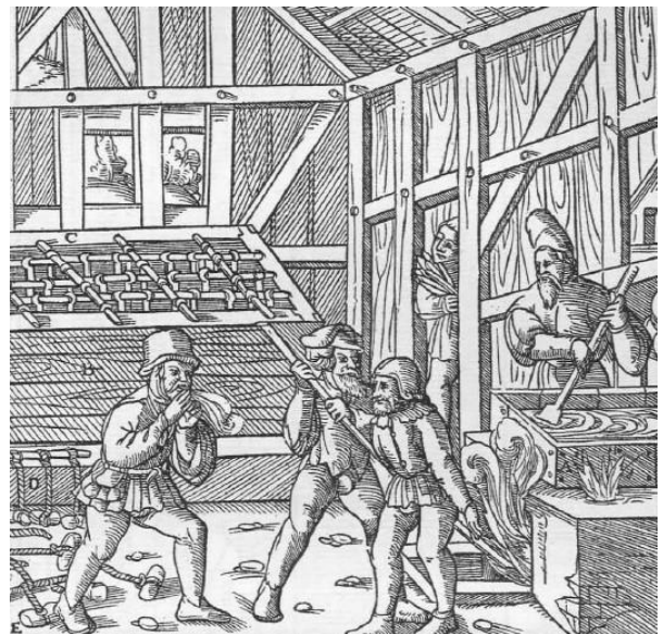
Abb. 1215: Das Sieden von Vitriolwasser und das Auskristallisieren des Vitriols. Die Pfanne A. Der Trog B. Die rostartigen Stäbe C. Die Schnüre D. Kleine Steine E.
