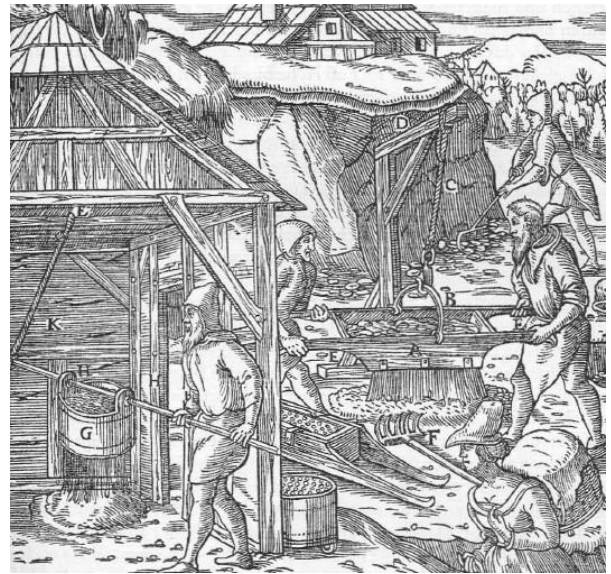
Abb. 816: Das Sieben auf andere Art. Das große Sieb A. Der halbkreisförmige Bogen B. Der Strick C. Der Galgen D. Die Handgriffe E. Der fünfzinkige Krähel F. Das kleine Sieb G. Seine Henkel H. Die Stange I. Der Strick K. Der Balken L.
