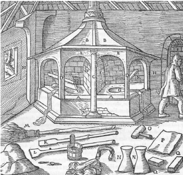
Abb. 1116: Ein Ofen zum Garmachen des Kupfers (Garherd). Der Herd des Ofen A. Die Abzugshaube B. Die gemeinsame Säule C. Die andere Säule D. Die Zwischenwand hinter der gemeinsamen Säule ist nicht sichtbar. Die Gewölbebogen E. Die Schutzwand, welche die gemeinsame Zwischenwand vor dem Angriff des Feuers bewahrt F. Die Schmelzgrube G. Die zweite Längswand H. Die Tür I. Das Brecheisen K. Das andere Brecheisen L. Der Besen mit daran befestigtem Stiel M. Die Stampfer N. Der Holzschlegel O. Die Blechplatte P. Unterlegsteine Q. Eisenstange R.
