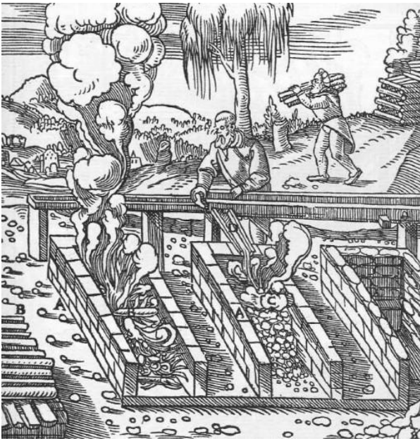
Abb. 864: Das Rösten des Kupfersteins in Stadeln. Der Stadel A. Das Holz B. Der Stein C. Ein kleines Gerinne D.
