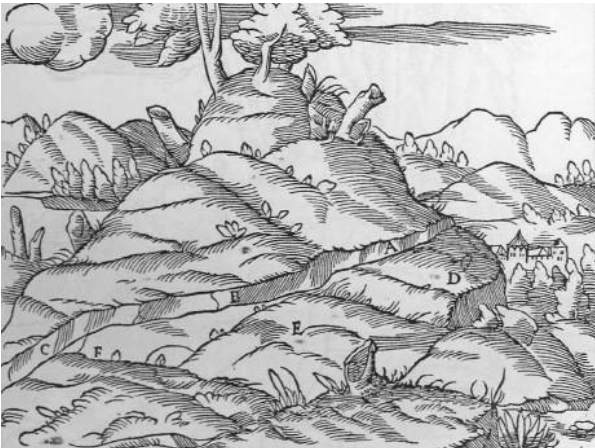
Abb. 309: Ein westöstlich streichender Gang. Der Gang A, B, C. Die Nebengesteinsschichten D, E, F.
