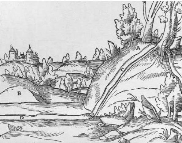
Abb. 320: Gang, der am Gehänge eines Berges herbstreich. Das Berggehänge A. Flaches Gelände B. Der Gang C, D
