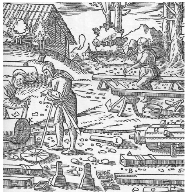
Abb. 812: Das Herrichten der Pochstempel und der Pochwelle. Ein Stempel mit Pochschuh A. Ein unten ausgeschnittener Stempel B. Der Pochschuh C. Ein anderer Pochschuh D [15]. Rechteckige Eisenringe E. Ein Keil F. Ein Hebling G. Die eckige Welle H. Ein Däumling I. Der Zirkel K.
