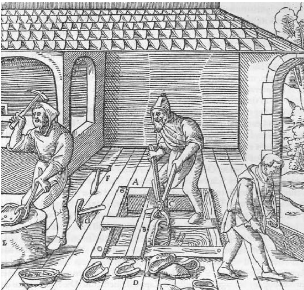
Abb. 1115: Das Ablöschen der Darrlinge und Abschlagen des Pickschiefers. Der Wasserbehälter A. Das Brett B. Die Zange C. Die aus dem Behälter herausgeholt Darrlinge D. Der Eichenklotz E. Der abgerundete Hammer F. Der Spitzhammer G.
