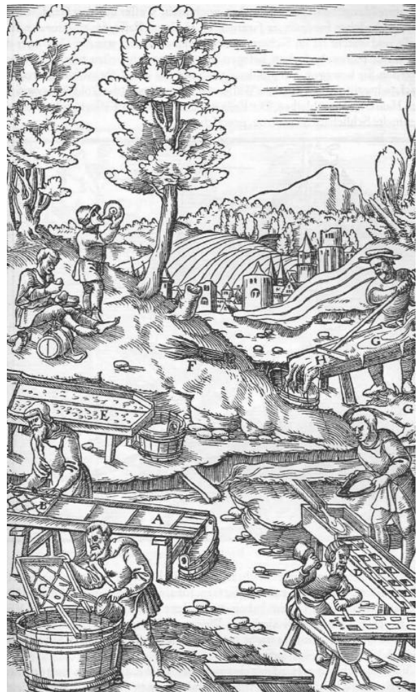
Abb. 845: Der Planenherd, dessen Haupt mit Grübchen und Rillen bedeckt ist. Der Herd aus rauhen Brettern. Der mit Fellen belegte Herd. Der Herd mit viereckigen Vertiefungen. Der Planenherd A. Sein Haupt mit Vertiefungen und Rillen B. Das abgenommene Haupt wird in einem Fasse gewaschen C. Der Herd mit rechteckigen Vertiefungen D. Ein Herd, an dessen Brettern kleine Flitterchen hängen bleiben E. Besen F. Stierhäute G. Die Kiste H.
