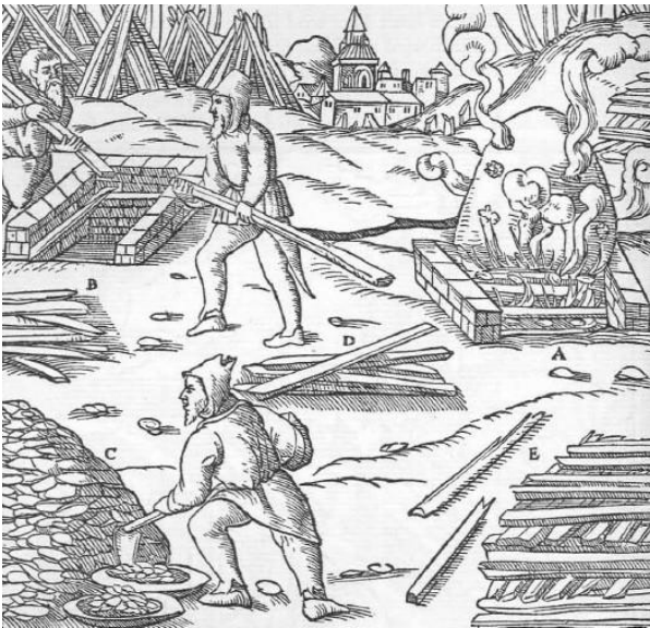
Abb. 807: Röststadel anderer Bauart. Der angezündete Röststadel A. Ein Röststadel, der hergerichtet wird B. Das Erz C. Der Erzhaufen auf dem Röststadel D. Der Holzhaufen E.
