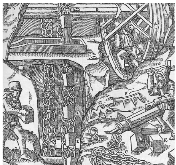
Abb. 622: Bulgenkunst mit Tretrad. Das Tretrad A. Die Welle B. Die doppelte Kette C. Ein Glied der doppelten Kette D. Die Kannen E. Eine einfache Klammer F. Eine dreimal gekrümmte Klammer G.
