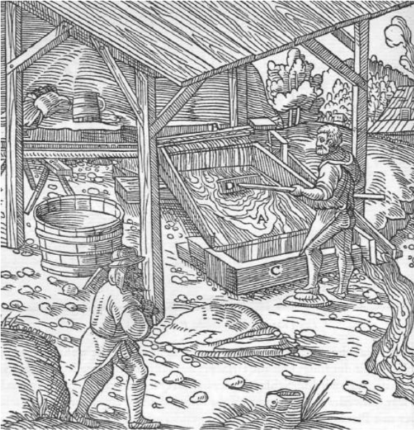
Abb. 828: Das Waschen der Erze auf dem kurzen Herd. Der Herd A. Das Gerinne B. Der Quergraben C. Die Kiste D.
