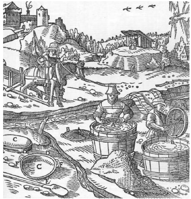
Abb. 819: Das Setzen in geflochtenen Körben. Der Korb A. Seine Handgriffe B. Der Trog C. Sein hinterer Teil D. Sein vorderer Teil E. Die Handgriffe F.
