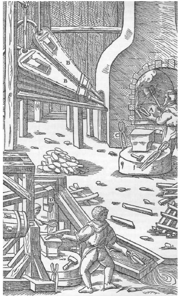
Abb. 925: Frischfeuer zur Stahlbereitung. Das Frischfeuer A. Die Blasebälge B. Die Zangen C. Der Hammer D. Das fließende Wasser E.
