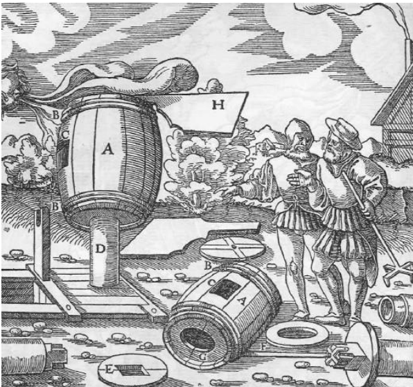
Abb. 641: Wetterhut. Das hölzerne Faß A. Die Reifen B. Die Windöffnung C. Das Rohr D. Die Scheibe E. Die Achse F. Die Öffnung im Boden des Fasses G. Der Flügel H.
