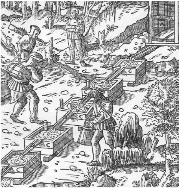
Abb. 1222: Die Gewinnung von in Stollenwässern fortgeführten festen Bestandteilen. Das Stollenmundloch A. Das Gerinne B. Die Behälter C. Die Überläufe D.
