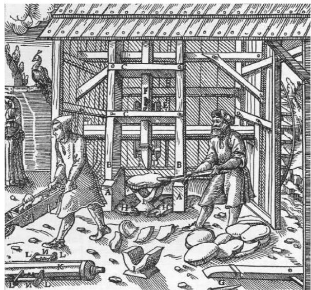
Abb. 1104: Das Zerkleinern des Schwarzkupfers unter einem Rammbär. Der Tragklotz A. Die Tragsäulen B. Die Querriegel C. Der Kopf des Stempels D. Seine Nocken E. Seine Öffnung F. Der Eisenstock G. Die Bleiblöcke H. Der bronzene Sattelbock I. Die Welle K. Ihre Heblinge L. Das Rundeisen M. Das Kupferrohr N.
