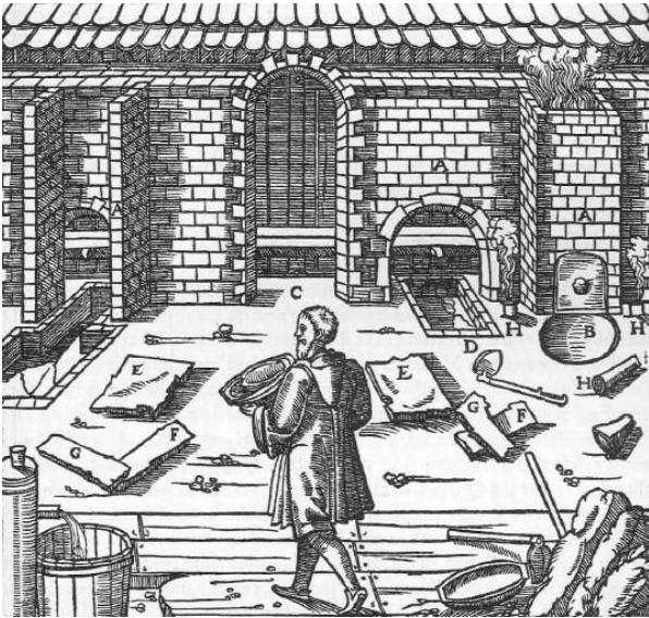
Abb. 902: Noch nicht zugestellte Schachtöfen. Die Schmelzöfen A. Der Vorherd B. Die Tür C. Der versenkte Feuchtigkeitsbehälter D. Platte zum Bedecken desselben E. Gemauerter Kanal F. Platten zum Bedecken desselben G. Rohr, durch das die Dämpfe entweichen H.
