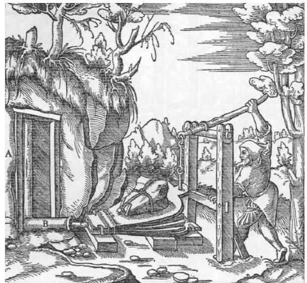
Abb. 647: Wetterversorgung mit blasend wirkendem Blasebalg. Der Stollen A. Die Rohre B. Das Mundstück des doppelt wirkenden Blasebalges C.
