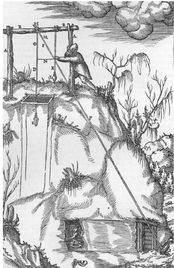
Abb. 507: Die Anordnung zur Ausführung der Dreiecksmessung bei einer Schachtlotung. Das Joch A. Das Querholz B. Der Schacht C. Die erste Schnur D. Das Gewicht der ersten Schnur E. Die zweite Schnur F. Ihre Befestigung im Boden G. Der Anfang der ersten Schnur H. Das Stollenmundloch I. Die dritte Schnur K. Das Gewicht der dritten Schnur L. Das erste Maß M. Das zweite Maß N. Das dritte Maß O. Das Dreieck P.
