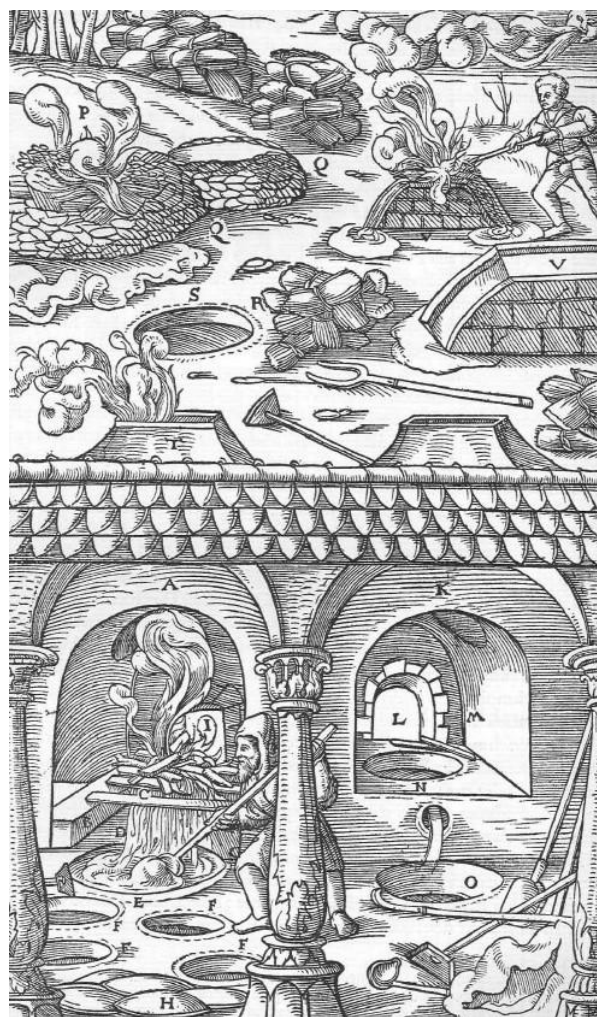
Abb. 917: Der kärntner, sächsische, westfälische und ungarische Bleiherd. Der Kärntner Ofen A. Die eine niedrige Mauer B. Holz C. Das Erz mit dem heraustropfenden Blei D. Der große Tiegel E. Die kleine Tiegel F. Die Kelle G. Bleikuchen H. Die rechteckige Öffnung in der Rückwand des Ofens I. Der sächsische Ofen K. Die Öffnung in der Rückwand des Ofens L. Holz M. Der obere Tiegel N. Der untere Tiegel O. Das Schmelzverfahren der Westfalen P. Kohlenhaufen Q. Stroh­bündel R. Die flachen Bleikuchen S. Der Tiegel T. Der ungarische Herd V.
