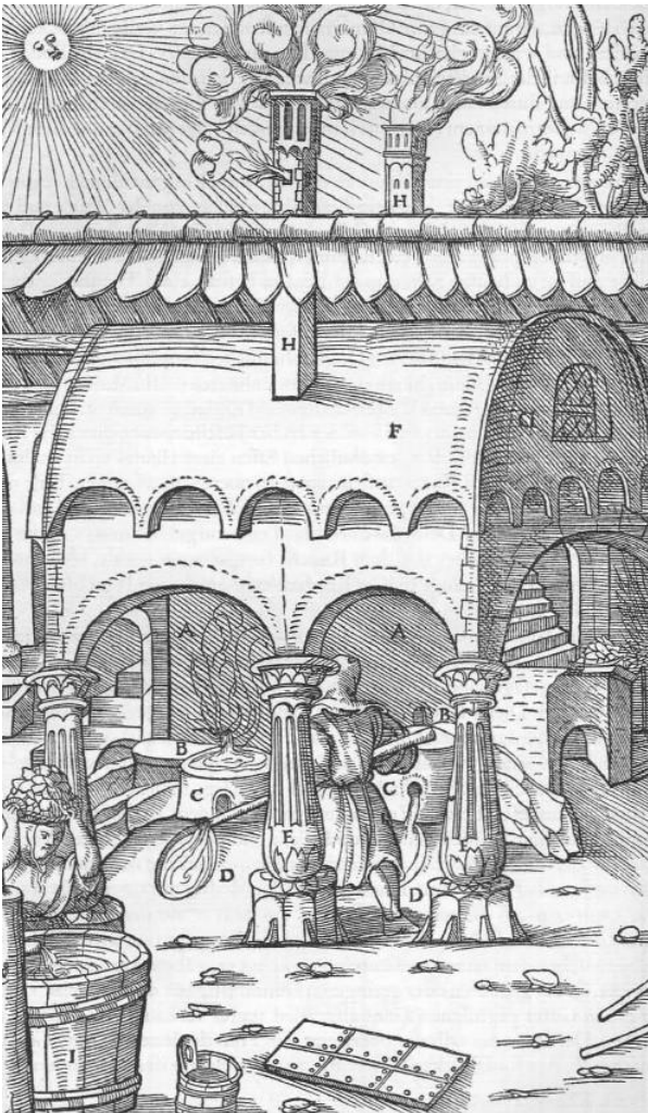
Abb. 920: Zwei Zinnschachtlöfen mit gemeinsamer Flugstaubkammer. Die Öfen A. Der erste am Ofen befindliche Vorherd B. Sein Stich C. Der zweite Vorherd D. Die Pfeiler E. Die Flugstaubkammer F. Fenster G. Die Rauchfänge H. Gefäß, in dem die Kohlen gewaschen werden I.
