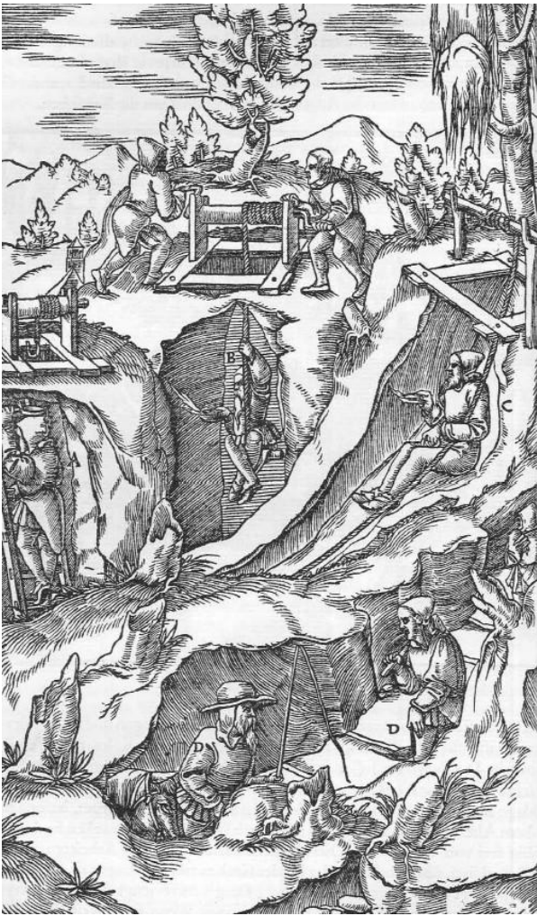
Abb. 650: Die verschiedenen Arten der Fahrung. Ein Bergmann, der auf der Fahrt einfährt A. [45] Einer, der auf dem Knebel sitzt B. Einer, der auf dem Leder einfährt C. Auf Stufen, die im Gestein hergestellt sind, Einfahrende D.
