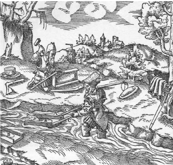
Abb. 850: Das Waschen des Goldsandtes im Läutertrog. Der Läutertrog A. Seine Aushöhlung B. Seine Handhaben C.
