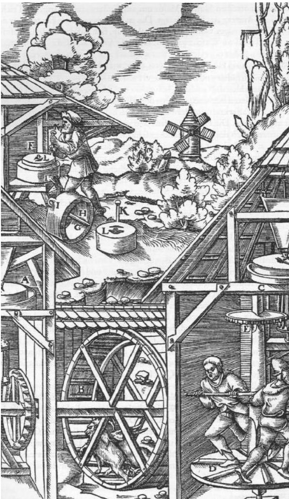
Abb. 821: Das Mahlen der Erze mit dem Tretrade und mit der Tretscheibe. Die erste Mühle A. Das von Ziegen getretene Rad B. Die zweite Mühle C. Die Scheibe an der stehenden Welle D. Deren Kammrad E.
