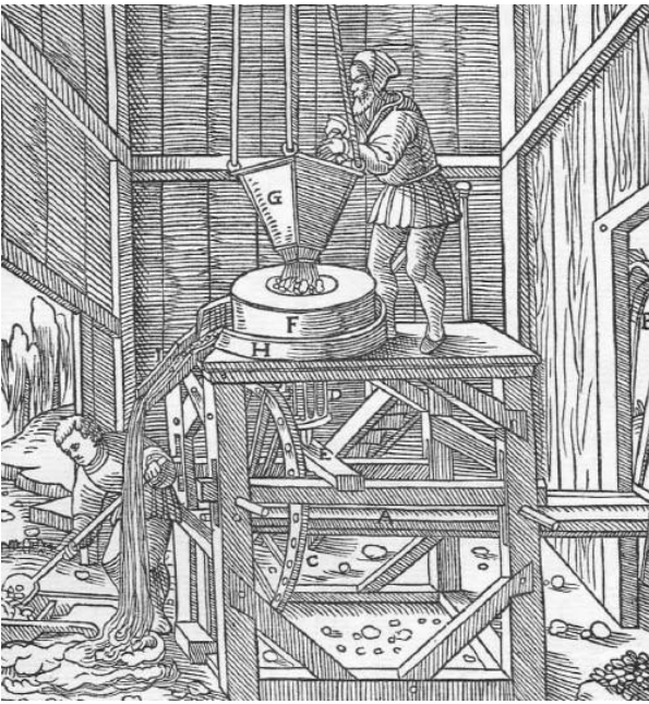
Abb. 820: Das Mahlen der Erze mit Wasserkraft. Die Wasserradwelle A. Das Wasserrad B. Das Kammmrad C. Das Getriebe D. Seine eiserne Welle E. Der obere Mühlstein F. Der Trichter G. Das hölzerne runde Gerinne H. Der Austrag I.
