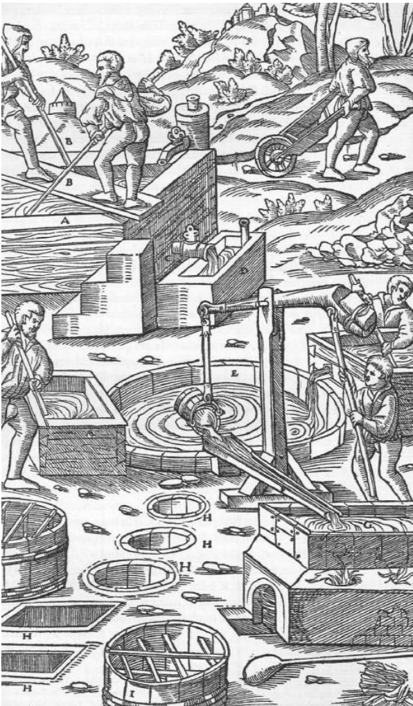
Abb. 1212: Die Gewinnung von Alaun aus Wässern. Der große Behälter A. Stangen B. Der Zapfen C. Wanne D. Der runde Behälter E. Die Rinne F. Die Bleipfanne G. In die Erde eingegrabene Gefäße H. Kufe mit Stäben I.
