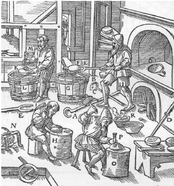
Abb. 1016: Das Herausnehmen des fein gebrannten Silbers. Das Gezäh mit kreisförmigem Haken A. Die Kelle B. Deren Loch C. Das zugespitzte Eisen D. Die Gabel E. Der Silberkuchen, auf einem klemmenförmigen Gezäh liegend F. Das Gefäß voll Wasser G. Der Klotz mit darauf liegendem Kuchen H. Der Hammer I. Das Silber, das ebenfalls auf einem klemmenförmigen Gezäh liegt K. Ein anderes Gefäß voll Wasser L. Die Messingbürste M. Der Dreifuß N. Der andere Klotz O. Der Meißel P. Der Herd des Ofens Q. Noch rauchender Testscherben R.
