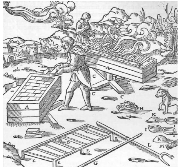
Abb. 934: Aussaigern von Wismut auf einer Feuerstätte mit eisernem Rohr, die in einer drehbaren Kiste eingebaut ist. Die Kiste A. Ihre Achse B. Die kreuzweise verbundenen Balken C. Der Rost D. Seine Füße E. Das brennende Holz F. Die Stange G. Die Gußform, in der das Wismut zusammenschmolzen wird H. Kleinere Gußformen I. Metallkuchen K. Die zweizinkige Gabel L. Der Besen M.
