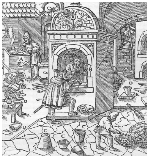
Abb. 1004: Die Scheidung des Goldes vom Silber im Guß mit Schwefelantimon. Der Windofen A. Der Goldschmiedeofen B. Der Tontiegel C. Der Eisentiegel (Gießbuckel) D. Der Klotz (Stock) E.
