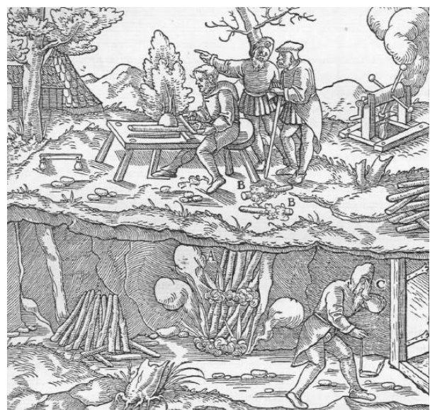
Abb. 504: Das Feuersetzen. Das angezündete Holz A. Bärte B. Der Stollen C.
