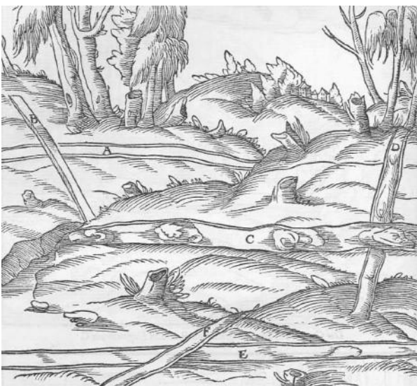
Abb. 334: Massige, drusige und taube Gänge und Trümmern. Ein massiger Gang A. Ein massiges Trum B. Ein drusiger Gang C. Ein drusiges Trum D. Ein tauber Gang E. Ein taubes Trum F.
