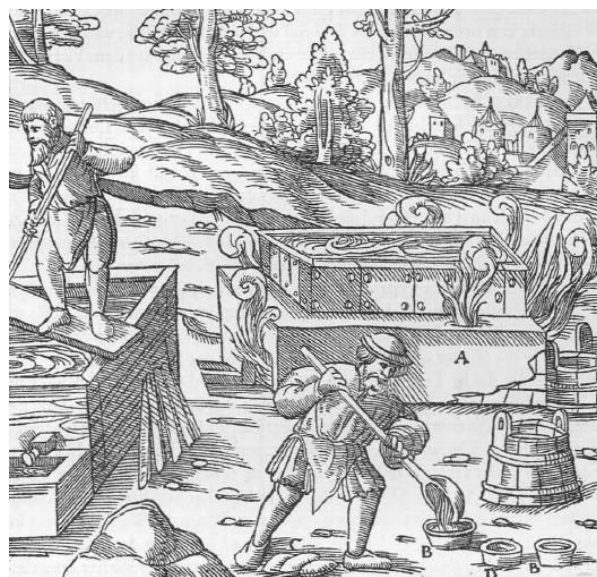
Abb. 1217: Das Verwittern und Auslaugen vitriolbildender Mineralien. Die Pfanne A. Die Näpfe B. Kuchenförmige Stücke C.
