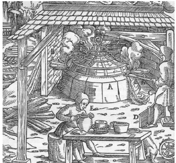
Abb. 1008: Ein in Betrieb gesetzter Treibofen. Der Ofen A. Die Holzscheite B. Die Silberglätte C. Das Blech D. Ein hungriger Meister ißt Butter, damit das Gift, welches der Herd ausatmet, ihm nicht schadet; denn sie ist ein Spezialmittel dagegen E.
