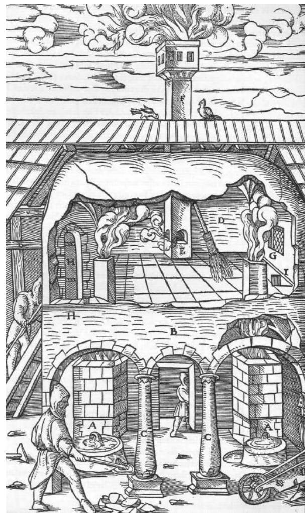
Abb. 918: Flugstaubkammer über den Schachtöfen. Die Öfen A. Das Gewölbe B. Die Pfeiler C. Die Flugstaubkammer D. Die Öffnung E. Der Rauchfang F. Das Fenster G. Die Tür H. Der Kanal I.
